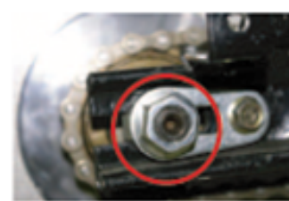
Piulițe ax spate – verificați-le periodic
