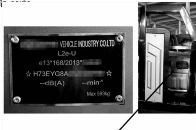
Figura 1-9 - localizare etichetă electrică
